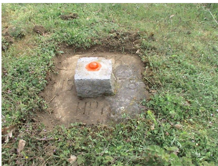
Бетониран каменен блок с гъбовиден болт (код 52)
